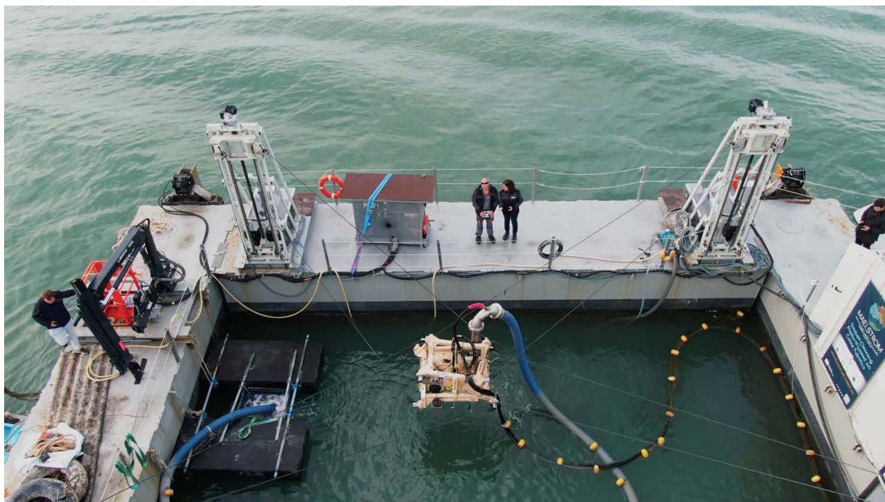
Piattaforma robotica per la pulizia dei fondali – progetto EU H2020 MAELSTROM
